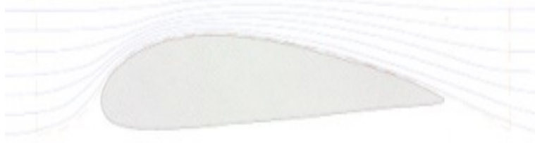
Hava akımının kanat etrafındaki hareketi (Şekil 4)
